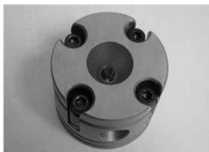
Рис. 5. Камера надвисокого тиску конструкції piston-cylinder Mao-type.
