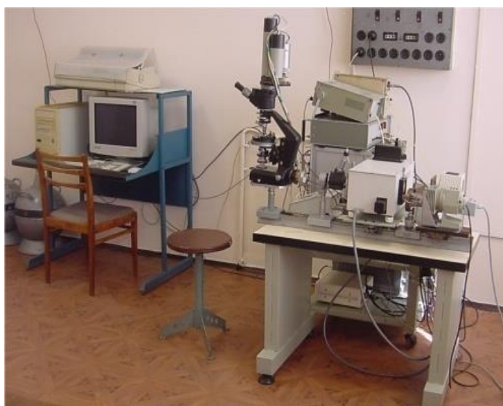
Рис. 3. Однопроменевий мікроспектрофотометр для вимірювання спектрів поглинання мінералів в УФ-, видимій і ближній ІЧ-областях спектру.
