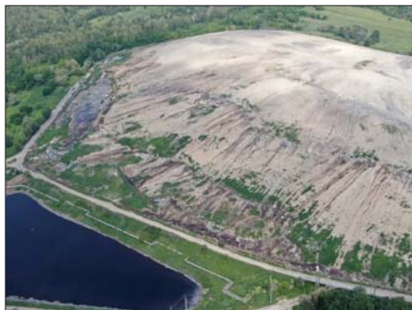
Рис. 2. Дистанційне зображення північно-західної частини майданчика "А" полігона № 5, зроблене з безпілотного літального апарата 31.05.2019, на якому простежуються місця височування фільтрату (чорно-коричневий колір) з "тіла" сміттєзвалища, стікання його по схилу і накопичення у підніжжі
