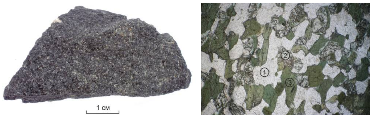
Рис. 4.9. Кристалосланці діопсидові з Рибальського кар'єру: 1 – плагіоклаз, 2 – піроксен, 3 – амфібол.. В шліфі збільшення 25. Ніколі -.
