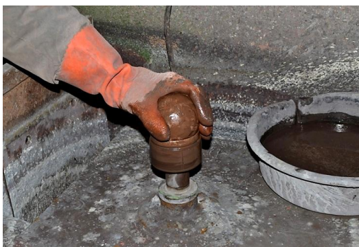
Рис. 5.7. Доведення заготовки кулі.
