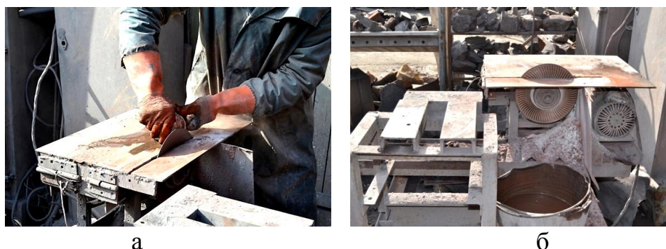
Рис. 5.6. Обдирання заготовки з метою надання їй необхідної форми.
