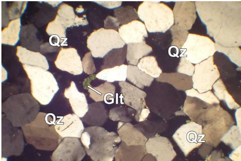
Рисунок 4.68 – Пісковик кварцитоподібний (камінь фундаменту Десятинної церкви, проба № 1/12 за таблицею 4.26).
